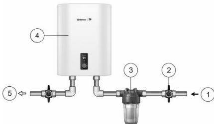
Рис.2 Схема подключения фильтра.
