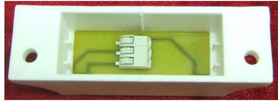
ДПМ-2 исп.03/2 клеммы экспрессмонтажа, Wago
