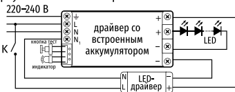
Схема подключения БАП в светильнике ДПБ-01-А
