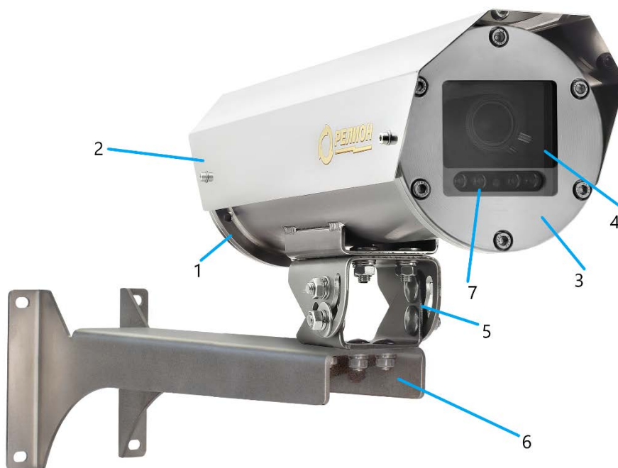
1 – основание с кабельным вводом; 2 – солнцезащитный козырек; 3 – лицевая панель; 4 – ударопрочное смотровое окно; 5 – болт крепления крепежно-юстировочного устройства; 6 – крепежно-юстировочное устройство; 7 – ИК-подсветка.
