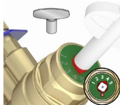
Рис.11 Настройка картриджей VT.PICC.G.03 и VT.PICC.G.
