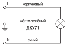
Рисунок 3. Схема присоединения светильника ДКУ71
