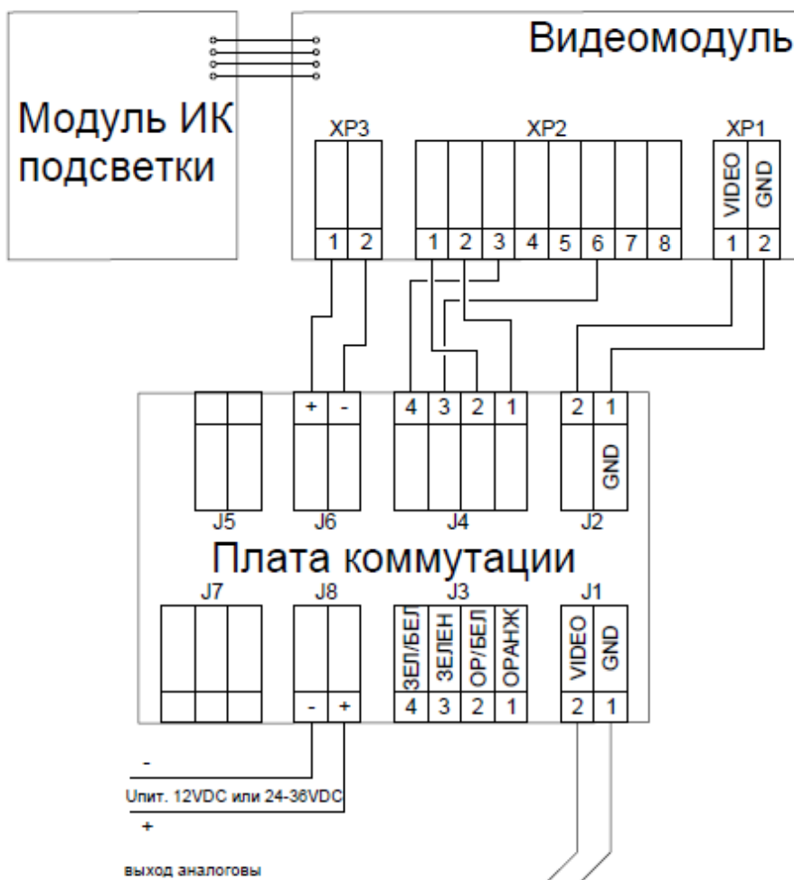
Рисунок 7.а. Схема подключения АHD видеокамер (Для исполнений АHD видеокамер без подогрева Упит. – 12VDC, для исполнений АHD видеокамер с подогревом Упит. – 12VDC или 24-36VDC)
