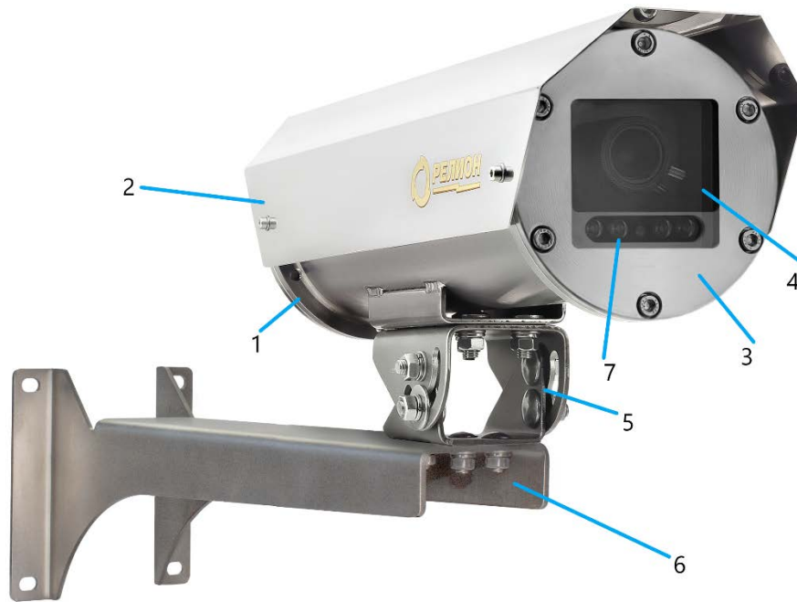
1 – основание с кабельным вводом; 2 – солнцезащитный козырек; 3 – лицевая панель; 4 – ударопрочное смотровое окно; 5 – болт крепления крепежно-юстировочного устройства; 6 – крепежно-юстировочное устройство; 7 – ИК-подсветка. Рисунок 5. Внешний вид видеокамеры Релион-Н-300-ИК
