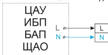
Рис. №1 Схема подключения к групповой цепи питания
