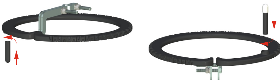
Рисунок 5 - Установка обрезиненного отвода и электрода-индикатора
