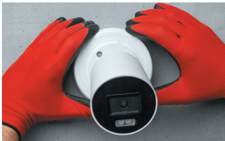
Обесточьте камеру и поверните крышку против часовой стрелки
