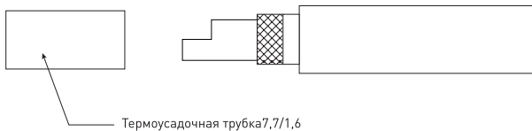
Рис. 9 - Нанесение первого слоя изоляции
