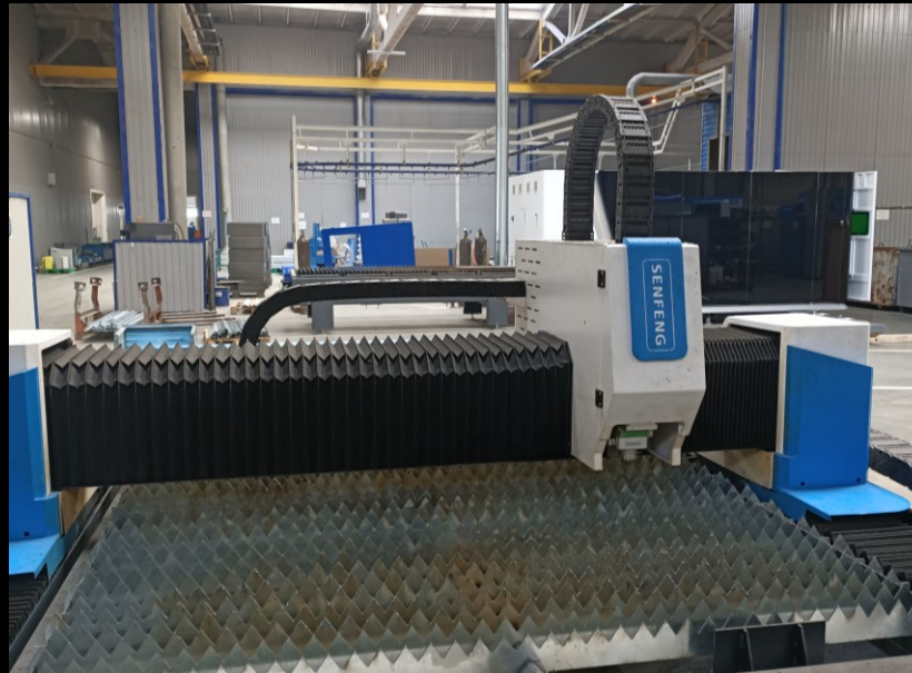
2 станка лазерной резки «BODOR» и «SENFENG»
