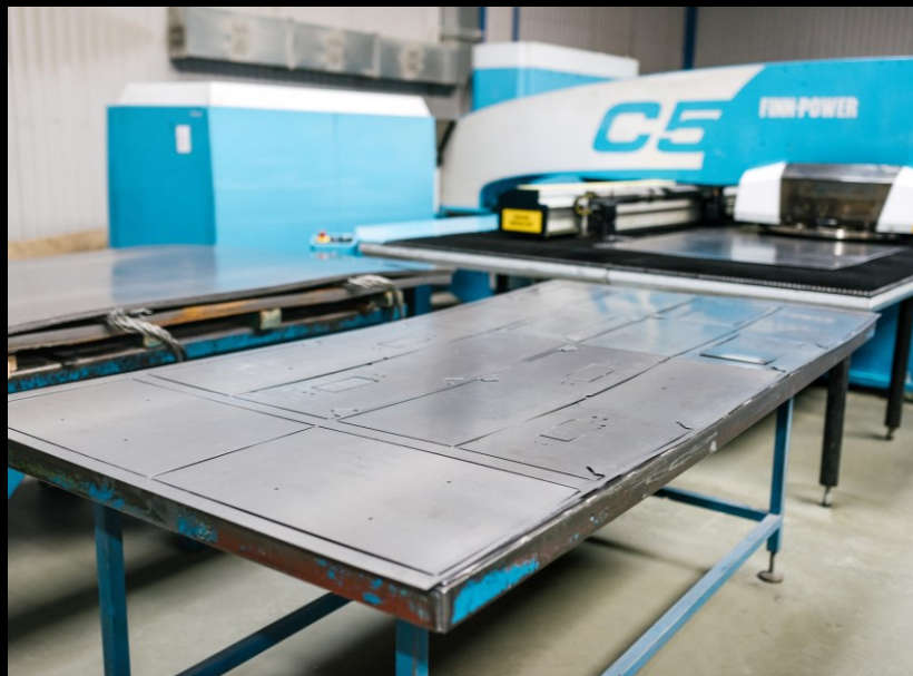
толщина обрабатываемого металла от 0,7 мм до 3 мм
