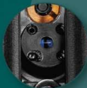
Магнитный компенсатор для самовыравнивания
