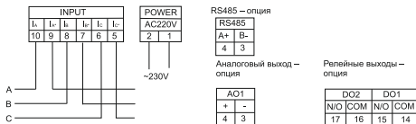
а) схема подключения 3-ф. амперметра при I \leq 5 A
