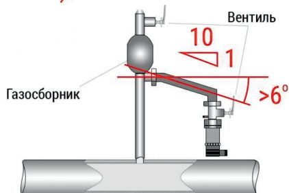
Рисунок 8 – Способы монтажа преобразователя для измерения давления жидкости
