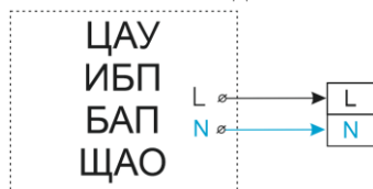
Рис. №1 Схема подключения к групповой цепи питания
