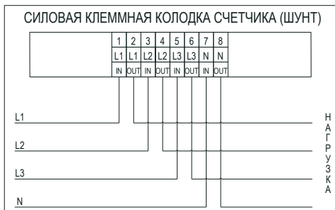
Рисунок 8 – Схема подключения счетчика к сети электроснабжения напрямую
