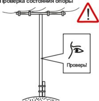
12а. Проверка состояния опоры
