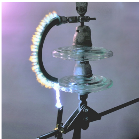
Рисунок 9 - Фотография разрядника при срабатывании
