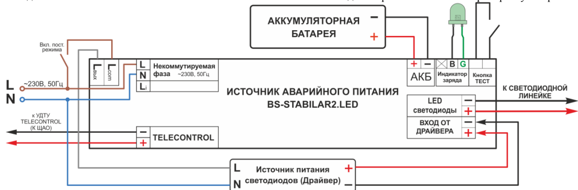
Рис. 2 Схема подключения BS-STABILAR-81-B3-LED и BS-STABILAR-83-B3-LED для аварийного светового прибора в непостоянном режиме:
