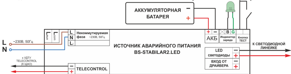
Рис. 2 Схема подключения BS-STABILAR-81-B3-LED и BS-STABILAR-83-B3-LED для аварийного светового прибора в непостоянном режиме:
