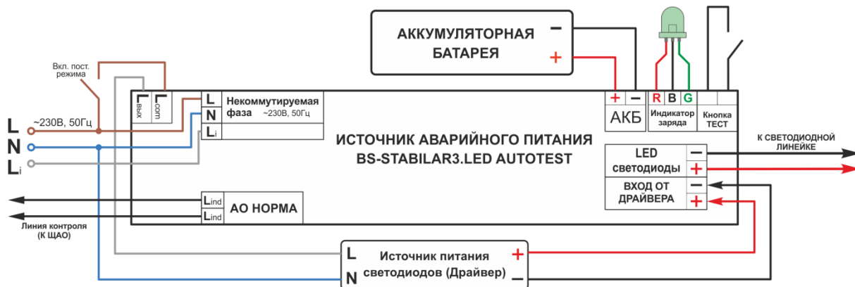
Рис. 2 Схема подключения BS-STABILAR3-81-B4-LED и BS-STABILAR3-83-B4-LED для аварийного светового прибора в непостоянном режиме:
