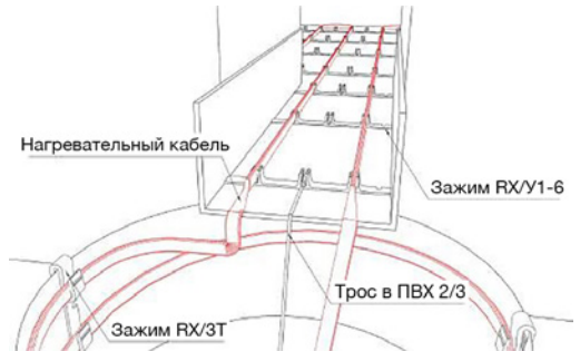
Рис. 4 (Монтаж нагревательного кабеля через парапет)
