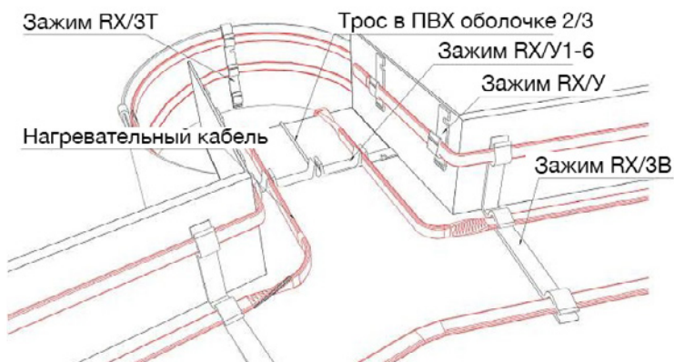
Рис. 4 (Крепление нагревательного кабеля возле водосточной воронки)
