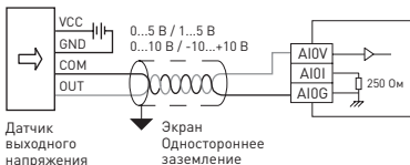
Рис. 5 – Подключение аналоговых входов (входной сигнал – напряжение)
