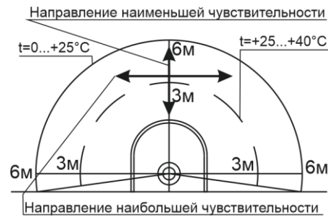
Рис. 8 – Радиус действия датчика в горизонтальной плоскости
