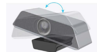
РЕГУЛИРОВКА УГЛА (±10°) ВЛЕВО И ВПРАВО
