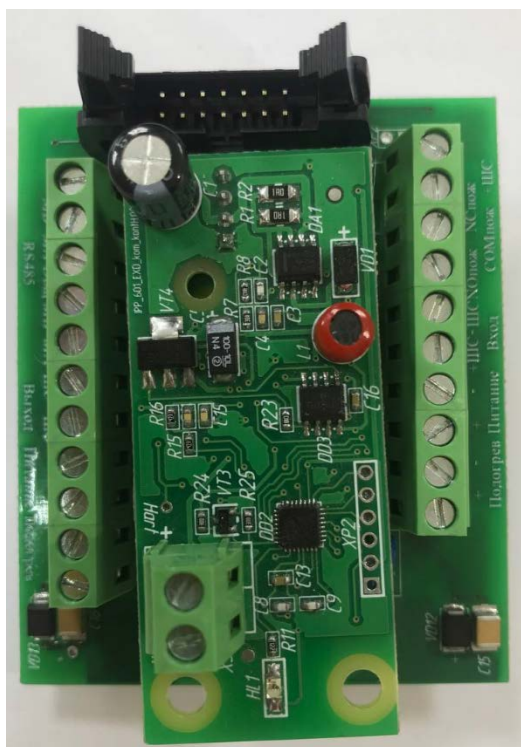
Рисунок 5 – Клеммная плата извещателя
