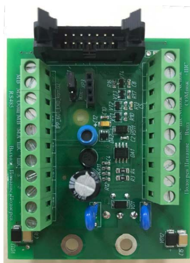
Рисунок 9 – Клеммная плата извещателя
