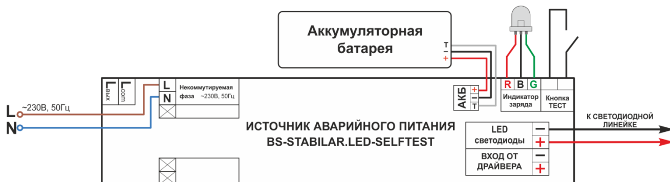
Рис. 2 Схема подключения БАП Stabilar2.LED для аварийного светового прибора в непостоянном режиме:
