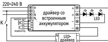
Схема подключения БАП в светильнике ДВО-08-А
