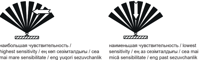
Рисунок 2 – Чувствительность датчика / Figure 2 – Sensor sensitivity / 2 сурет – Датчигінің сезімталдығы / Figura 2 – Sensibilitatea senzorului / 2-rasm – Sensori sezuvchanligi
