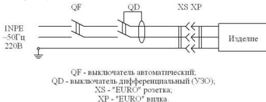
Рис. 1. Схема подключения изделия к электросети.
