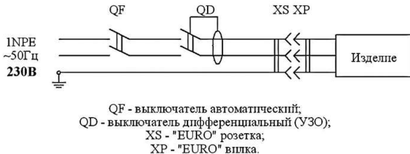
Рис.1. Схема подключения изделия к электросети.
