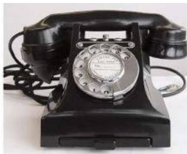
Рис. 140. Корпус телефонного аппарата, выполненный из бакелита
