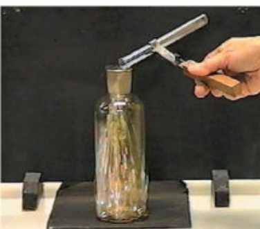
Рис. 115. Горение сурьмы в хлоре
