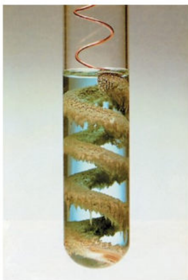
Рис. 120. Взаимодействие меди с раствором нитрата серебра
