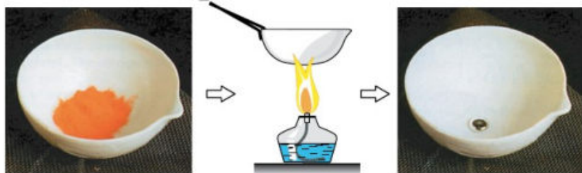
Рис. 94. Получение кислорода разложением оксида ртути
