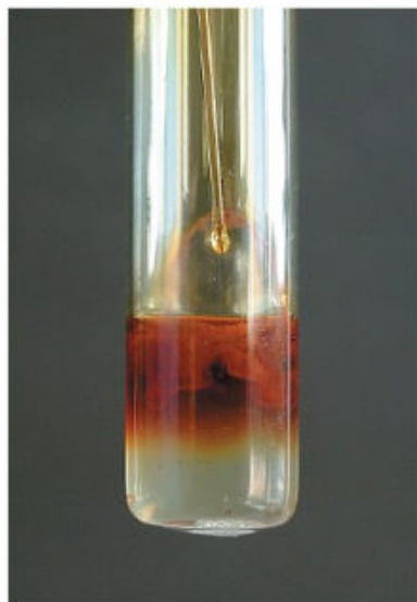
Рис. 125. Вытеснение брома из его соли более активным галогеном
