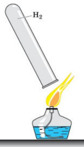
Рис. 54. Проверка водорода на чистоту
