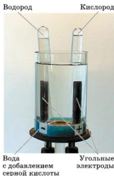
Рис. 114. Электролиз воды в лабораторных условиях
