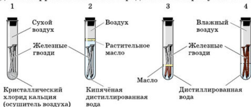
Рис. 121. Коррозия железа в различных условиях
