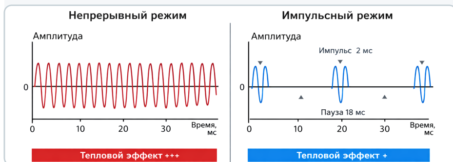
Сравнение непрерывного и импульсного режимов ультразвука
