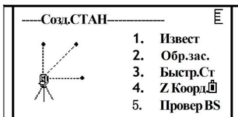
Рис. 12. Выбор режима установки станции обратной угловой засечки
