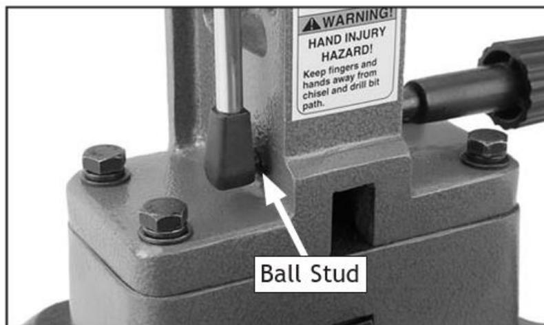
Рис. 12. Крепление газлифта к нижней части стойки.
