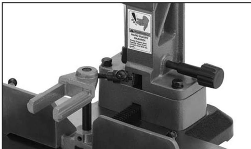
Рисунок 16. Установленный удлинительный блок.
