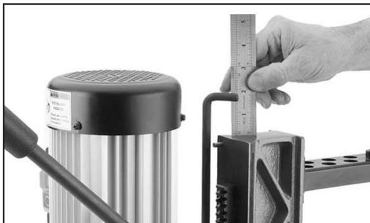
Рисунок 22. Регулировка ограничителя глубины с помощью линейки.
