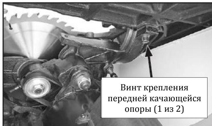
Рис. 71. Винт крепления передней качающейся опоры
