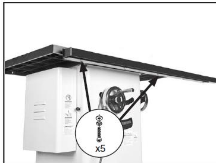
Рис. 16. Прямоугольная труба, закреплённая на передней направляющей
