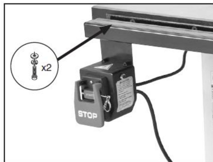
Рис. 21. Установленный магнитный пускатель
