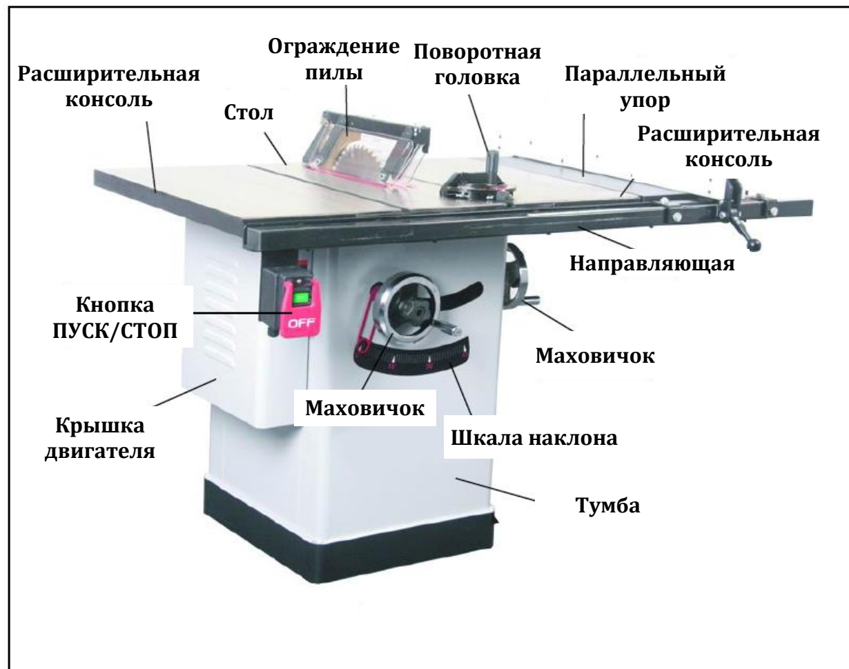
Рис. 1. Основные органы управления и элементы станка
