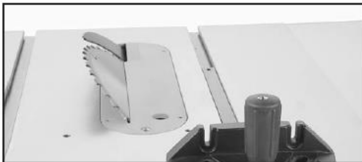
Рис. 45. Дисковая пила, наклонённая под углом 45^\circ для реза со скашиванием на типовой циркулярной пиле
