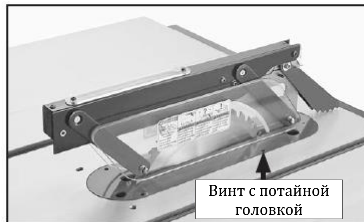
Рис. 36. Установленное ограждение пилы
