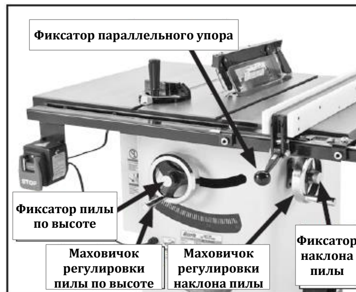
Рис. 24. Органы управления циркулярной пилой
