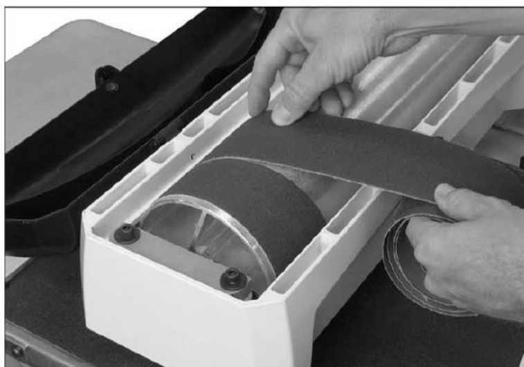
Рисунок № 4 Намотка абразивной ленты
