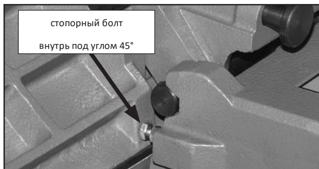
Рис. 64 Стопорный болт, направленный внутрь под углом 45°.
