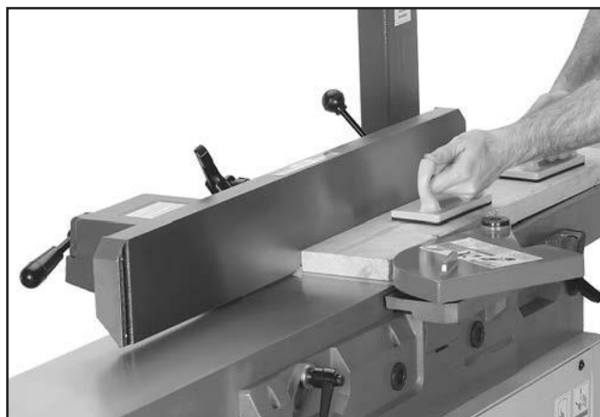
Рис. 31 Пример строгания поверхности.
