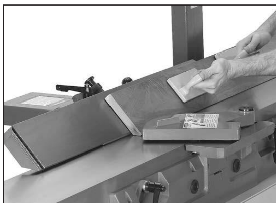
Рис. 35 Установка параллельного упора под 45°
