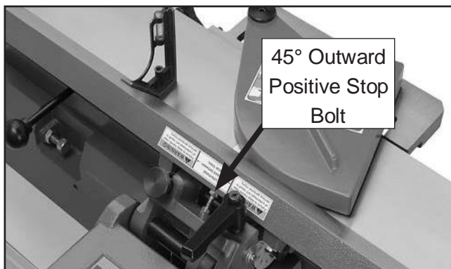
Рисунок 66. Регулировка параллельного упора 45° наружу.
