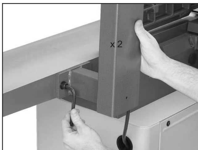
Рис. 14 Установка подставки для панели управления
