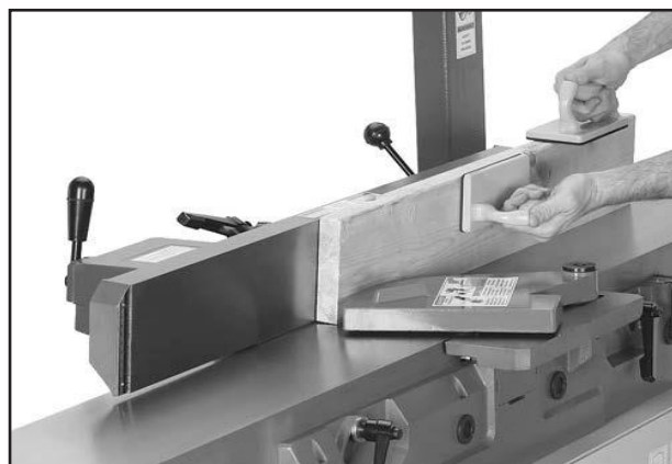
Рис. 33 Пример выравнивания кромки.
