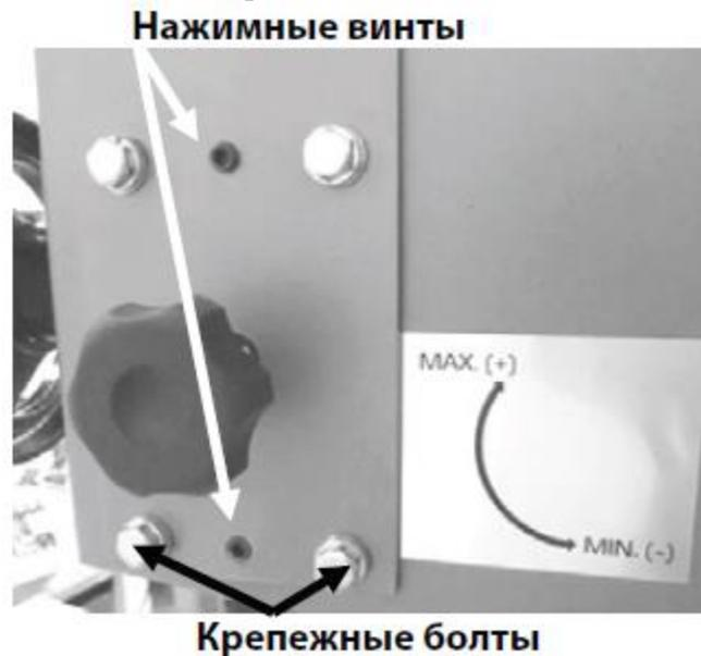
1. Здесь имеются четыре крепежных болта и два нажимных винта.
