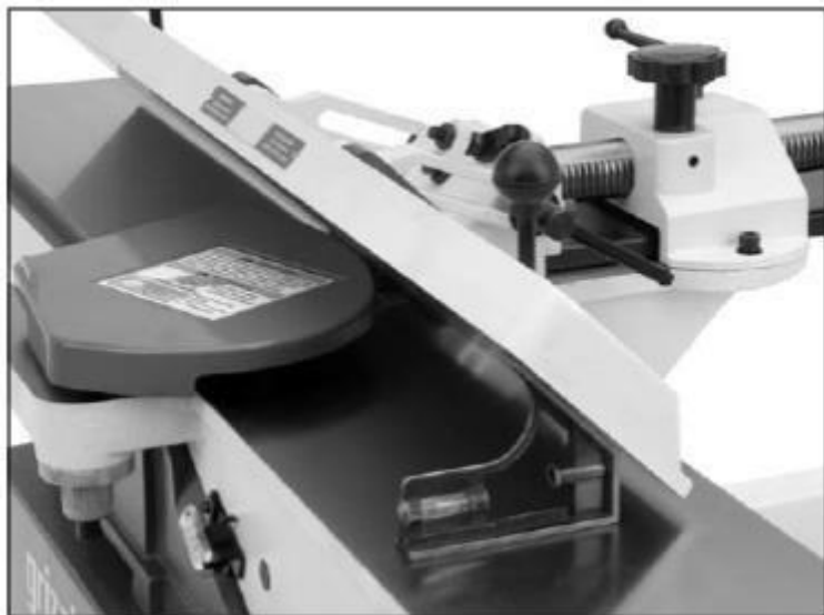
Рис. 24. Настройка под угол 45° внутрь
