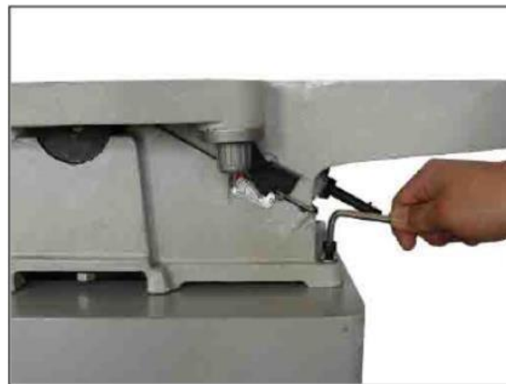
Рис. 4. Установка переднего крепёжного болта
