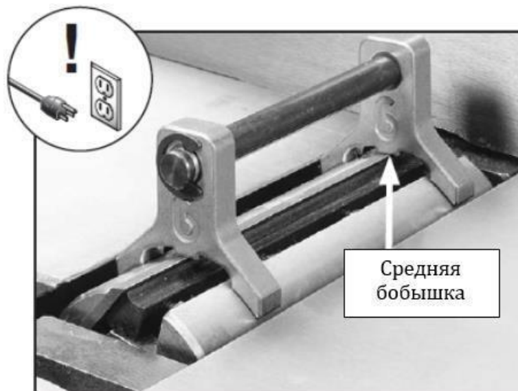
Рис. 20. Приспособление, установленное на ноже режущего вала
