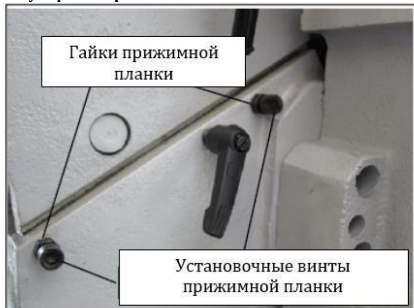
Рис. 30. Органы регулировки прижимных планок выводного стола
