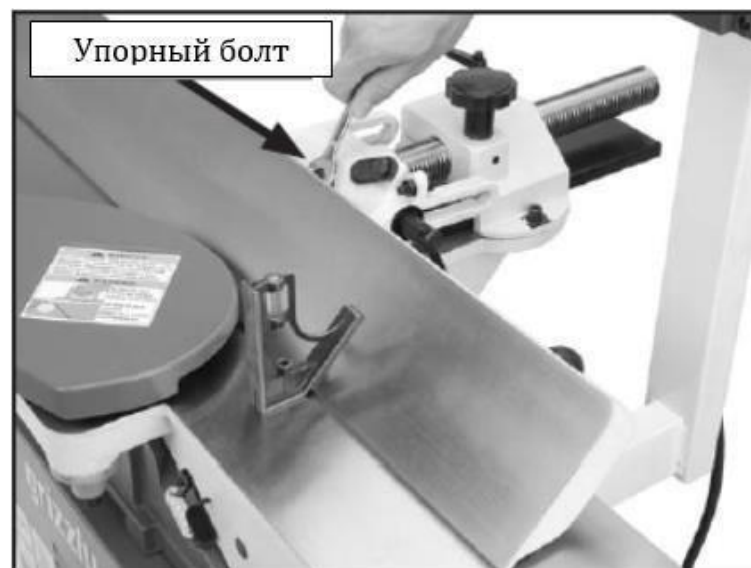
Рис. 29. Контргайка упора под углом 45° положения параллельного упора
