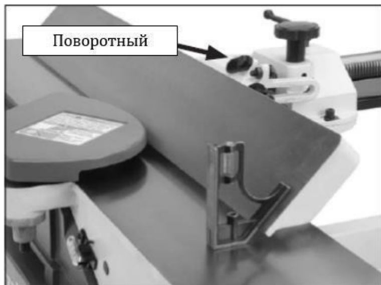
Рис. 28. Регулировка параллельного упора под углом 45° наружу
