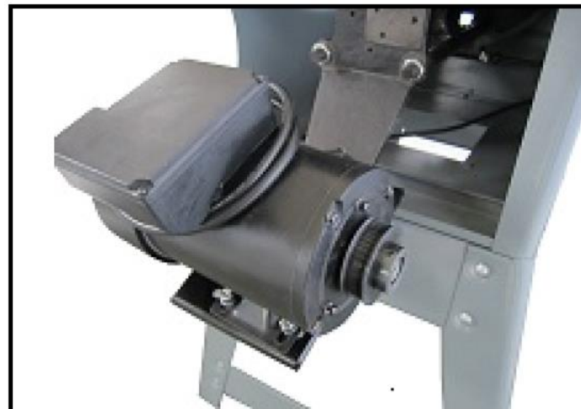
Рис. 23. Двигатель, закреплённый на монтажной плите
