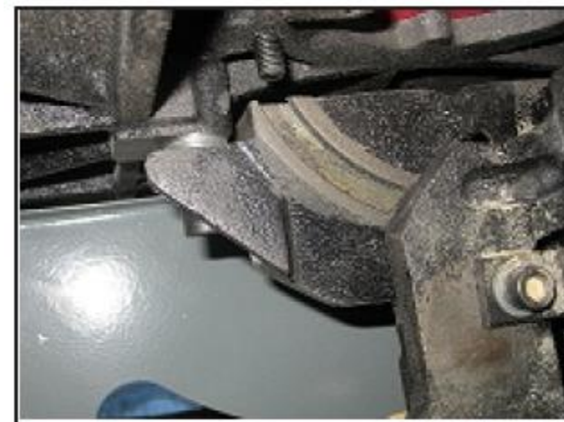
Рис. 33. Направляющие качающихся опор и червяк наклона
