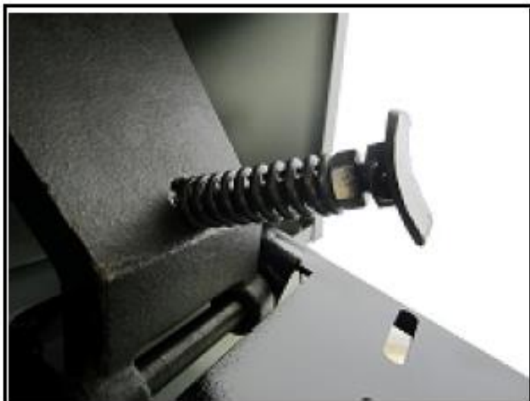
Рис. 22. Пружина регулировки натяжения ремня
