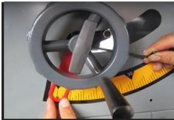
Рис. 37. Установка указателя на 0^{\circ}
