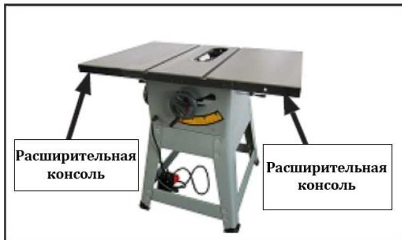
Рис. 13. Установленные на станке расширительные консоли
