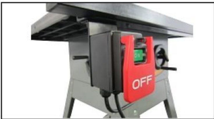
Рис. 19. Закреплённый на направляющей выключатель
