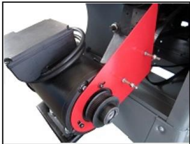
Рис. 24. Низ крышки ремня, прикреплённый к двигателю
