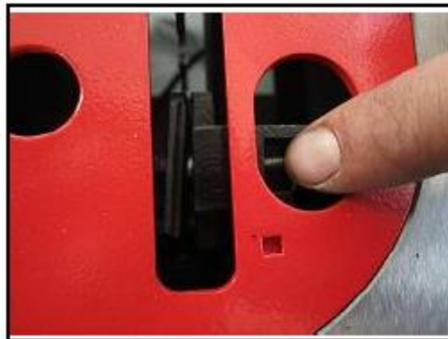
Рис. 28. Вставка стопорного штифта
