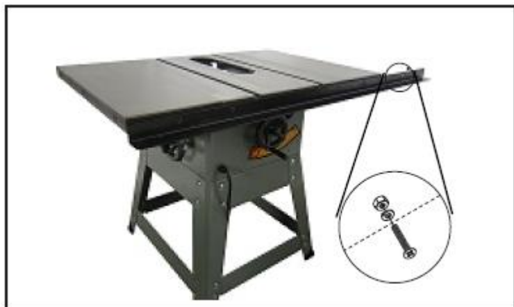
Рис. 16. Установленная на станке передняя направляющая
