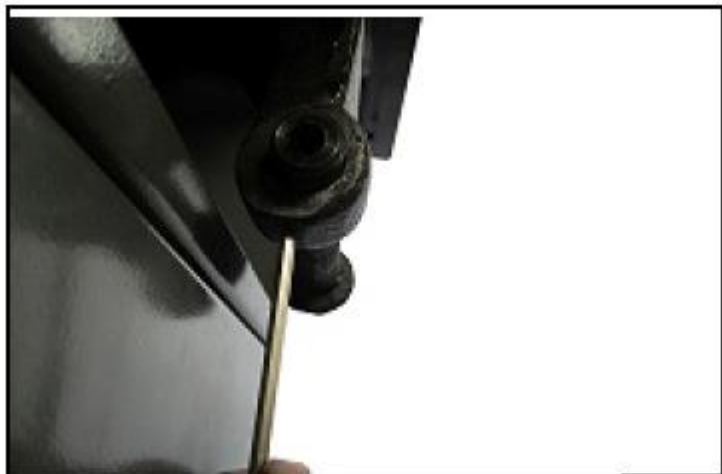
Рис. 20. Ослабить установочный винт на кронштейне двигателя
