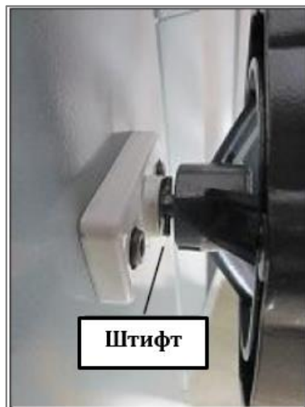
Рис. 11. Установленный на станке маховичок
