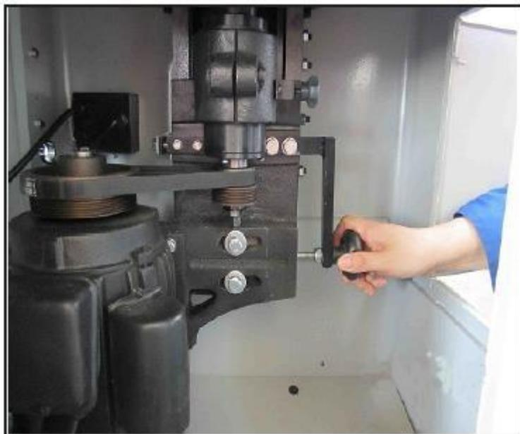
**Рис. 14.** Регулировка натяжения клинового ремня
