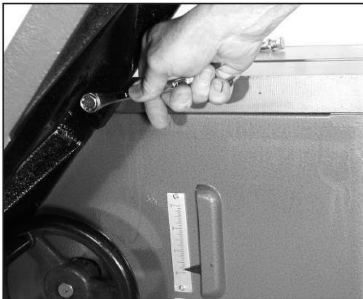
**Рис. 9.** Установка удлинительной консоли
