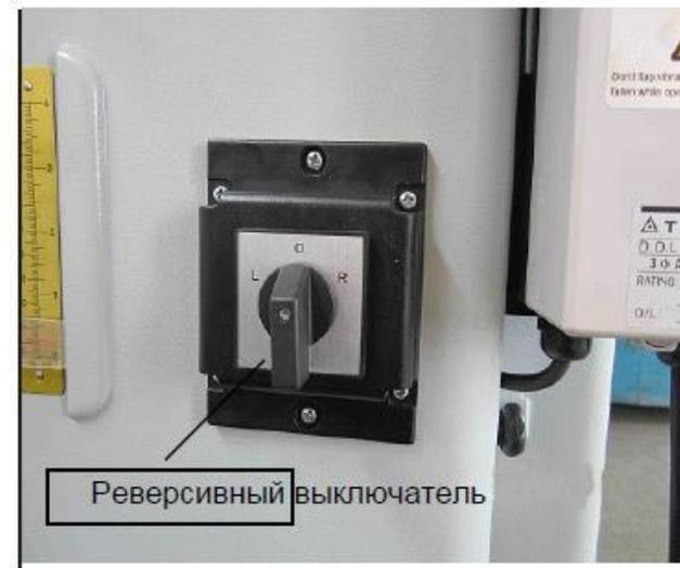
*Рис. 13.* Переключатель прямого и обратного вращения шпинделя
