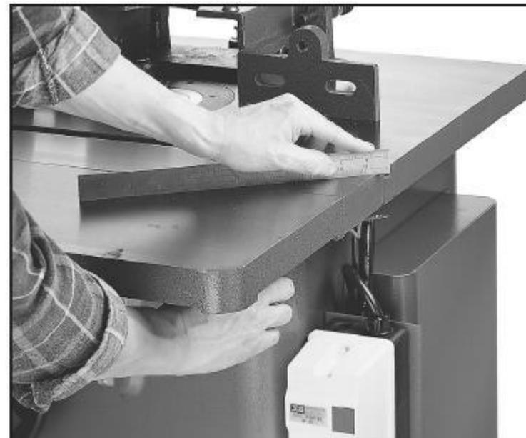
**Рис. 10.** Регулировка совмещения поверхностей
