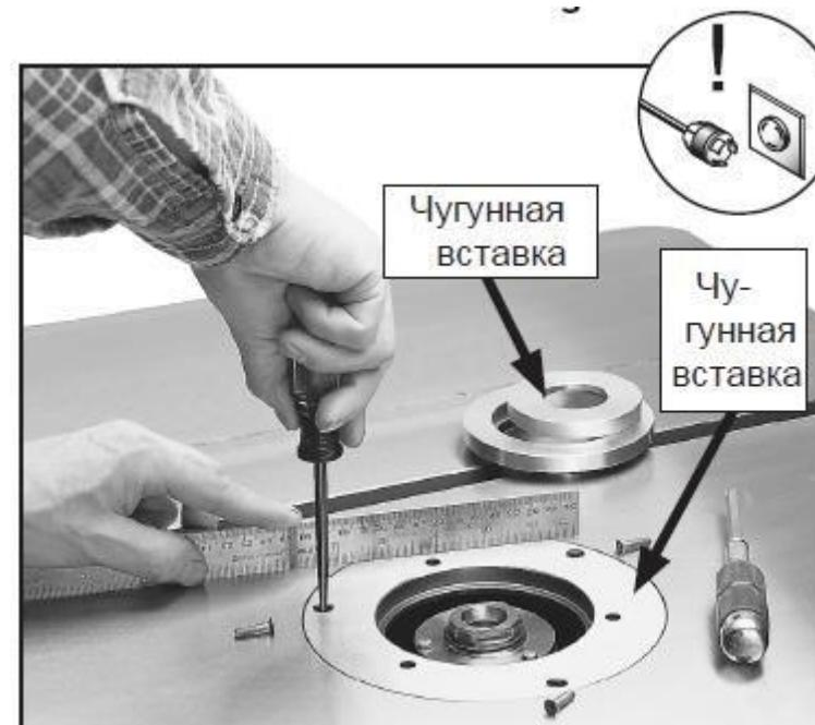
**Рис. 8.** Выравнивание вставки стола
