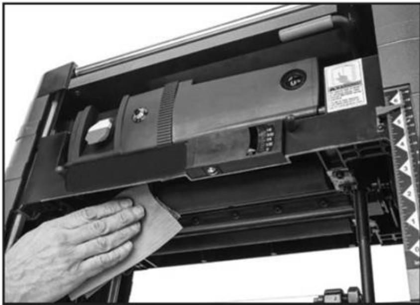
Рисунок 38. Очистка подающего ролика.
