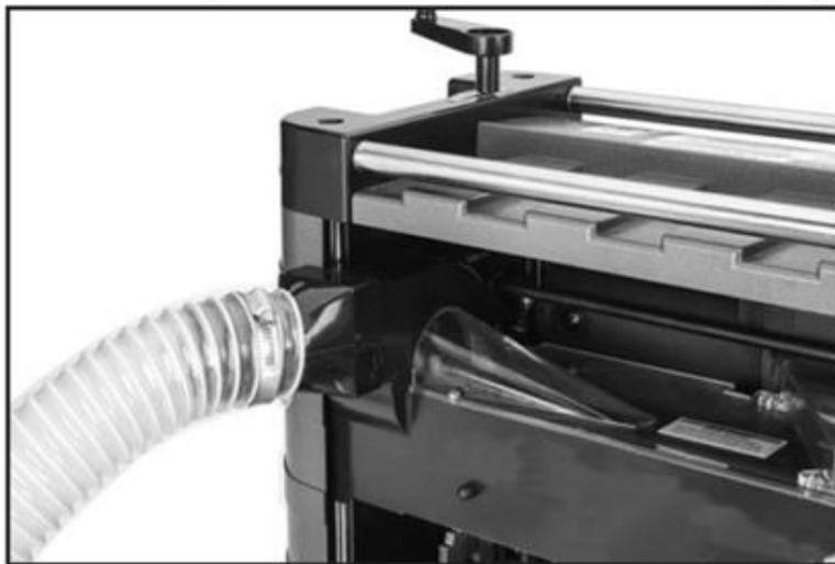
Рис. 12. Пылевой шланг, установленный на патрубок аспирации.
