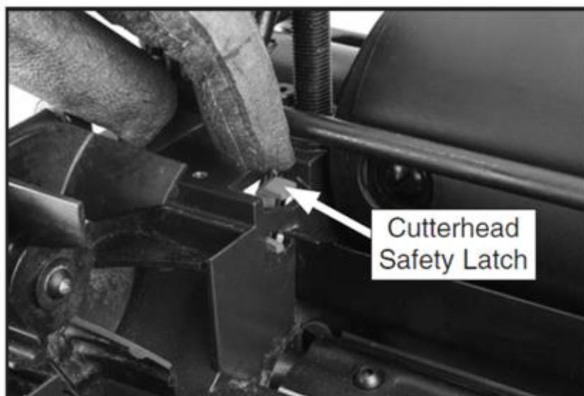
Рис. 22. Отсоединение фиксатора режущего вала.
