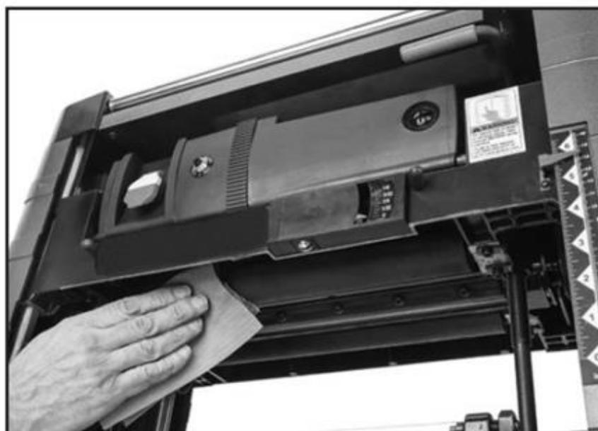
Рисунок 38. Очистка подающего ролика.
