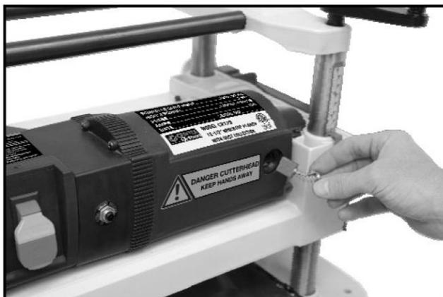
3. Установите новую угольную щетку и надежно прикрутите крышку щетки на место. Повторите шаги 2 и 3 при замене щетки с другой стороны двигателя.
