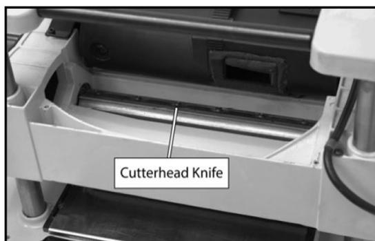
4. Открутите и выверните (6) колпачковые винты М6-1х16 с помощью прилагаемого шестигранного ключа диаметром 4 мм из комплекта поставки. 5. Как только винты будут извлечены из гйба, снимите гйб с помощью прилагаемых магнитов, затем извлеките ножи.
