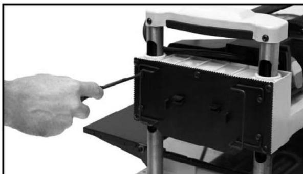
7. Установите патрубок аспирации опилок на корпус вентилятора, с противоположной стороны от крепежей для крепления провода питания. Он должен встать на место, затем затяните предварительно установленный винт с помощью шестигранного ключа диаметром 4 мм.
