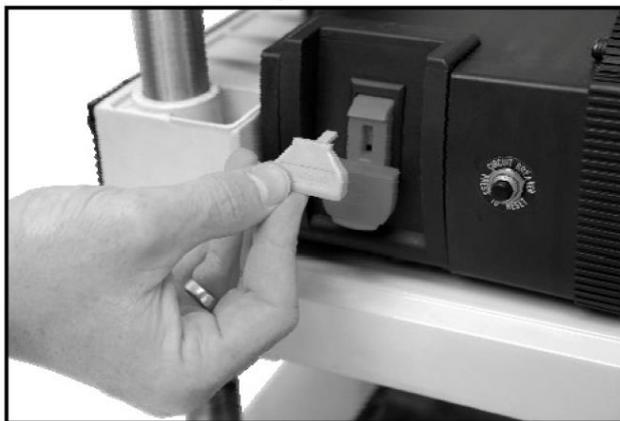
7. Теперь, когда предохранительный ключ вынут из главного выключателя, попробуйте запустить машину. Если машина не запускается, функция ключа безопасности работает должным образом.
