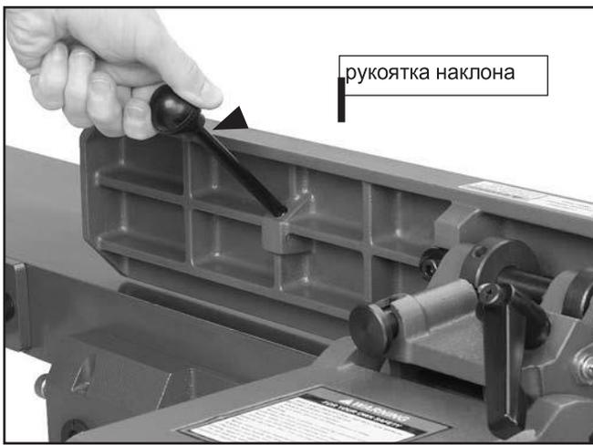
Рисунок 22. Установка рукоятки наклона параллельного упора.
