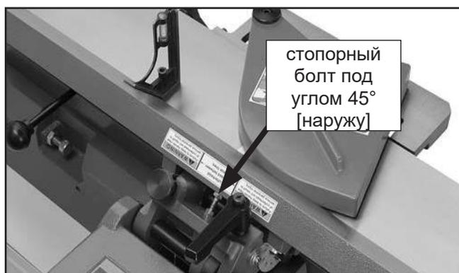
Рис. 66. Регулировка параллельного упора под углом 45° [наружу].
