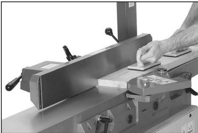
Рисунок 31. Пример строгания поверхности.
