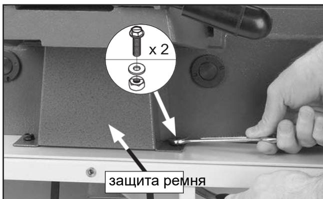
Рисунок 25. Установка защитного кожуха поли-клинового ремня.
