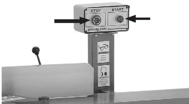
Рисунок 28. Расположение кнопок ОСТАНОВКИ [STOP]/ЗАПУСКА [START].
