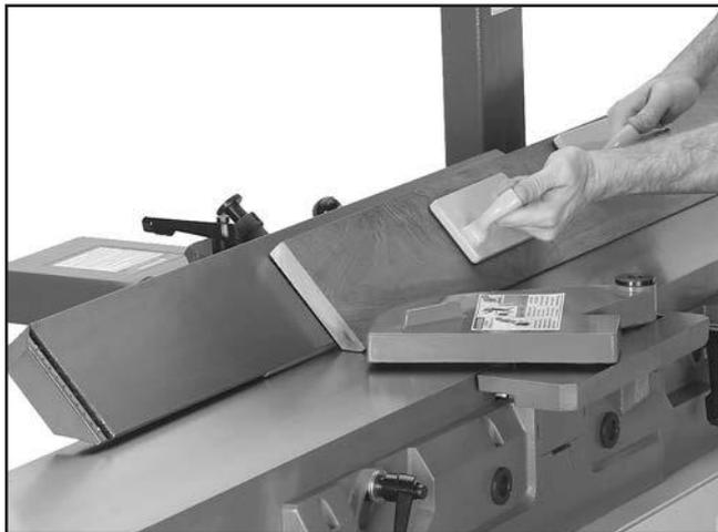
Рисунок 35. Установка параллельного упора для реза под углом 45°
