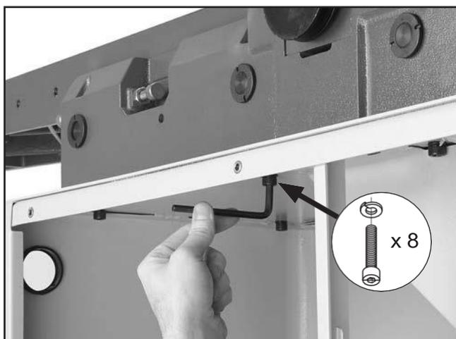
Рисунок 13. Крепление фуганок в сборе к стойке.
