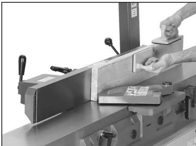
Рисунок 33. Пример операции соединения кромок.
