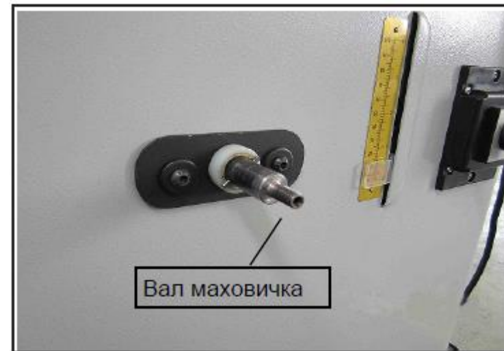
Рис. 3. Расположение вала маховичка
