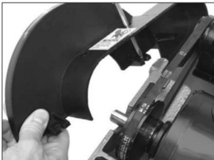
Рисунок 11. Удерживает на месте крепежную деталь крышки клинового ремня.
