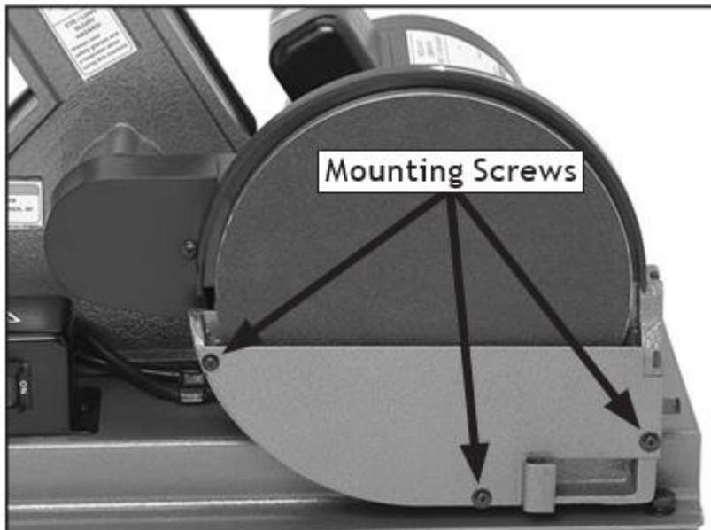
Рисунок 14. Установлена пылезащитная крышка диска.
