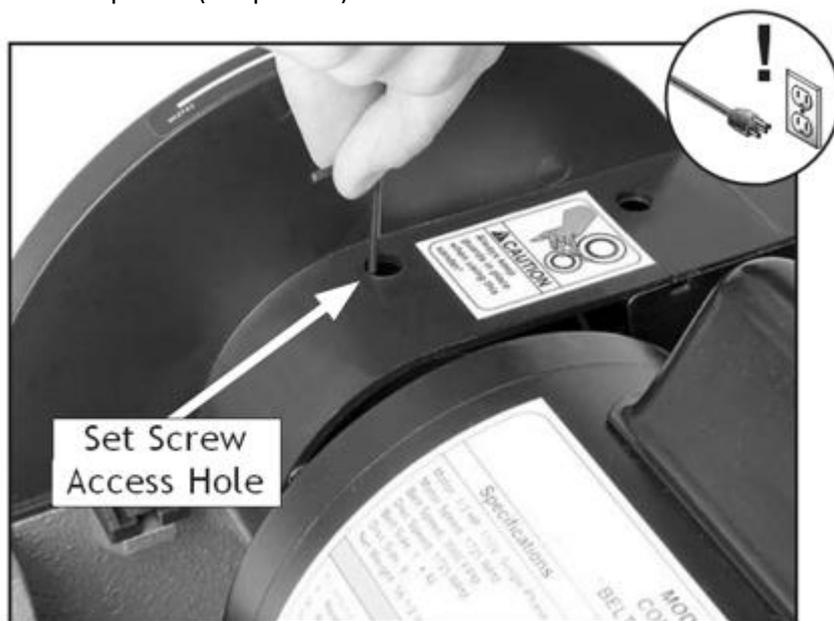
Рисунок 13. Закрепите установочный винт шлифовального диска.
