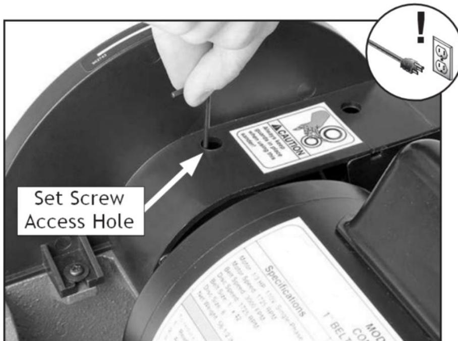
Рисунок 33. Расположение отверстия для установочного винта шлифовального круга.
