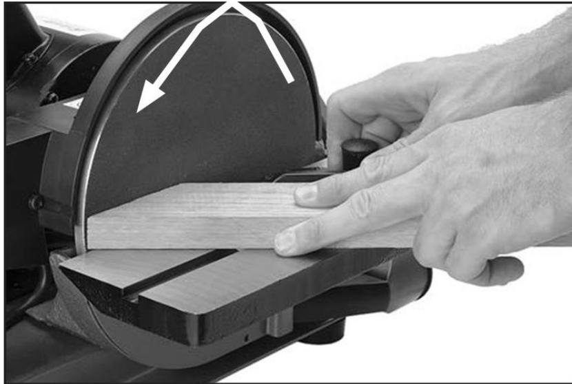
Рис. 25. Пример шлифования под углом.
