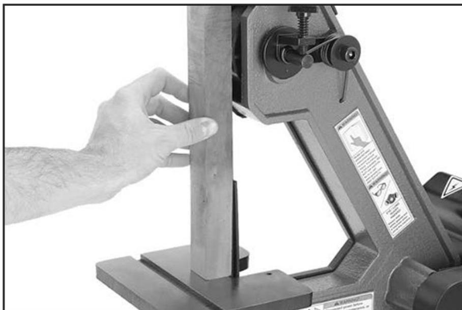
унок 27. Пример ленточного шлифования.
