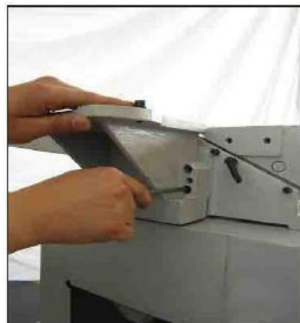
Рис. 9. Собранный кронштейн крепления каретки
