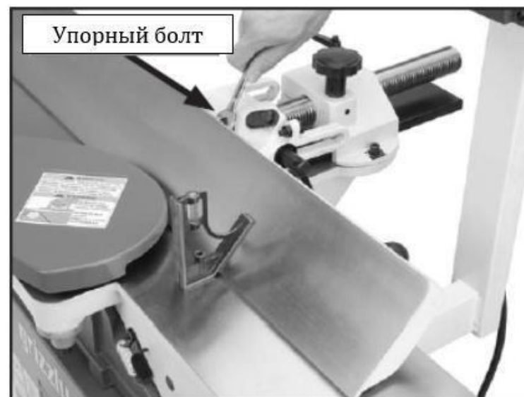
Рис. 29. Контргайка упора под углом 45° положения параллельного упора
