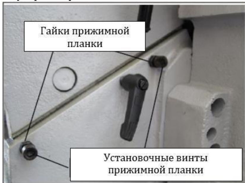
Рис. 30. Органы регулировки прижимных планок выводного стола
