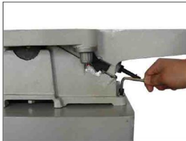
Рис. 4. Установка переднего крепёжного болта
