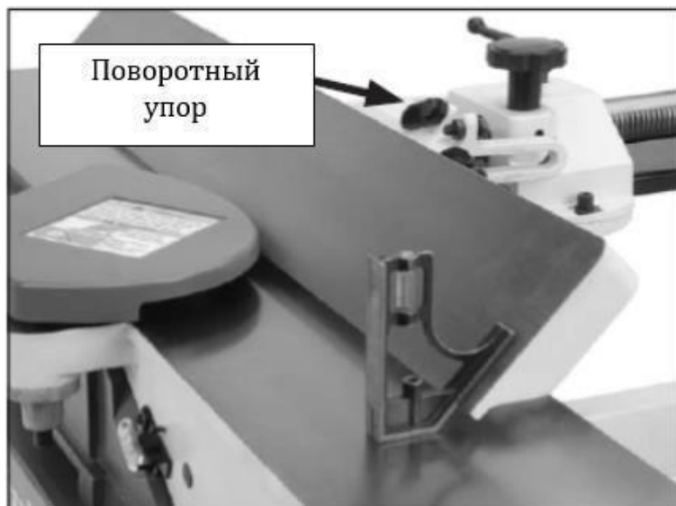
Рис. 28. Регулировка параллельного упора под углом 45° наружу
