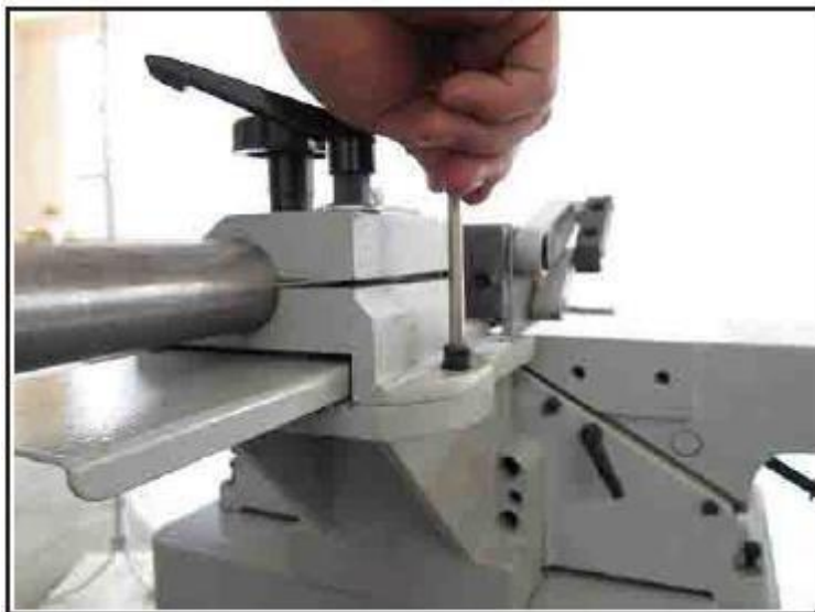
Рис. 10. Узел каретки параллельного упора
