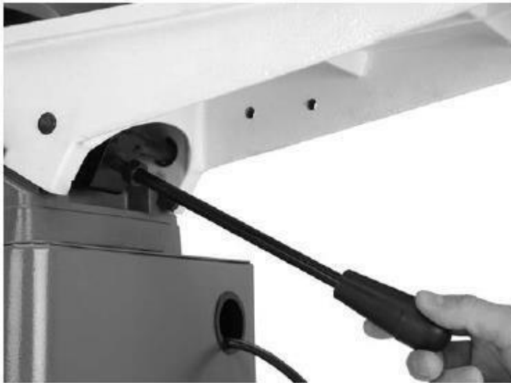
Рис. 16. Установка рычага подводного стола
